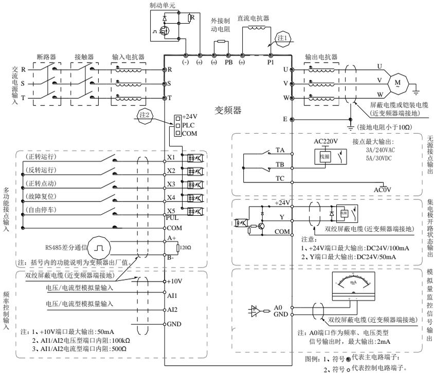
注 1: AC500 系列变频器直流电抗器为选配/标配内置, 不支持外部连接配置。
