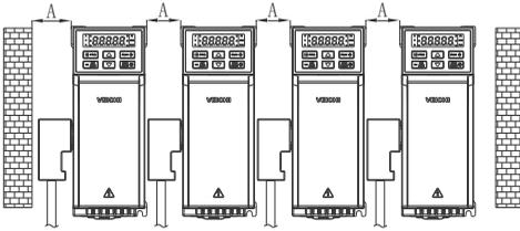
b. 并机安装间距 $A \geq 50\text{mm}$ （有通讯扩展卡）
